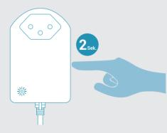
4 Die LEDs der beiden Adapter wechseln auf «konstant weiss» sobald die Powerline Verbindung erfolgreich hergestellt wurde. Ihr Gerät ist nun mit dem Internet verbunden.
